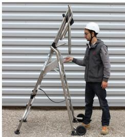
Se mettre sur côté de la plate-forme et soulever le plancher
