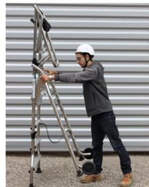
Replier la plate-forme en la mettant en appui sur le plan de montée
