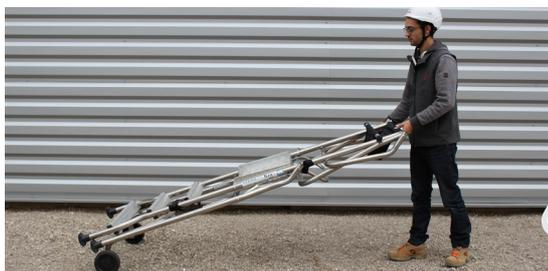
Déplacer **TOUJOURS** en position repliée, en soulevant le montant du garde-corps au niveau de la pochette porte-outils\*
