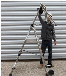
Soulever le garde-corps pour le positionner du côté du plan de support
